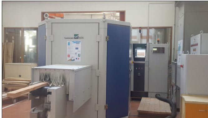
Photo 1 Scanner d'analyse optique et rayons X de l'ENSAM de Cluny Photo ENSAM
