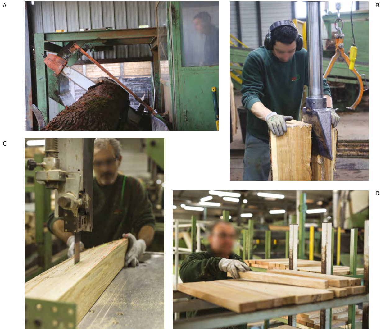
Photo 1 | Les quatre étapes nécessaires pour la transformation d'une grume en merrain : A : tronçonnage ; B : fente ; C : sciage ; D : empilage Photos : © archives Sylvain Bois
